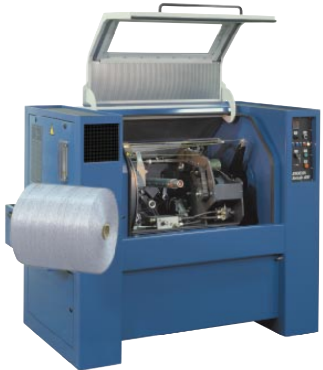
Nyudviklet twister anvendes til produktion af twistede garner. Newly developed twister is used to produce twisted yarns.
