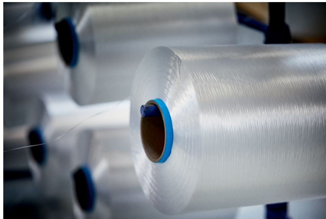
Kabelfibermateriale, Light-Flex, vandblokerende.
